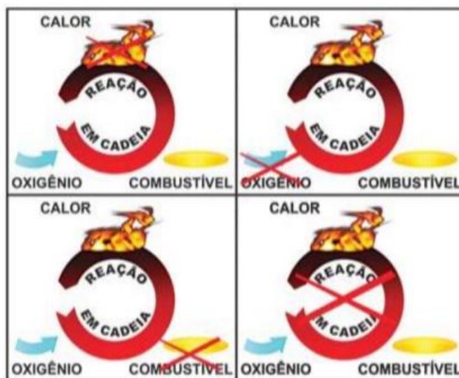
Figura – 2: Mecanismo de extinção do fogo
